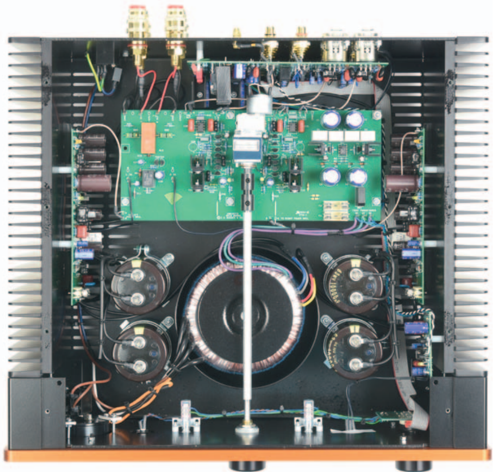
Einen Monster-Netztrafo benötigt man für 30 Watt Output nicht, dafür aber einen Ringkern, der sein Störfeld bei sich behält. Der motorisierte Pegelsteller sitzt dort, wo er hingehört: am Eingang.
