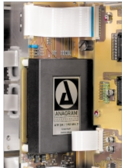
Das Besondere des Anagram-Wandlermoduls ist sein Samplerate-Converter
